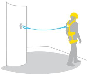
➤ trattenuta con punto di ancoraggio strutturale
