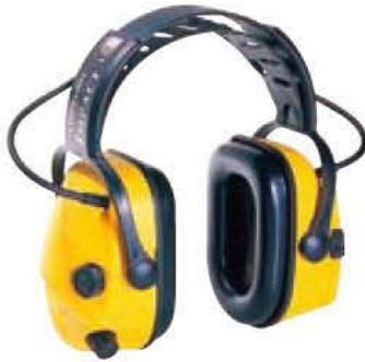
Abbattimento del rumore + amplificazione del suono. Microfoni stereo direzionali amplificano e migliorano il suono per un ascolto più naturale. Ideale per lavoratori con udito debole. Limitazione del rumore a 82dB. Durata della batteria 700 ore; funzione di spegnimento automatico. Nuovo accesso facilitato allo scomparto delle batterie.
