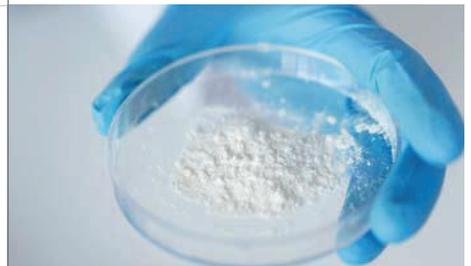
**D** Test opzionale protezione dalla norma EN 149:2001 di saturazione tramite polvere di Dolomite
