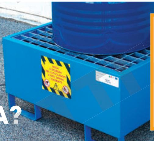
Proteggono le falde acquifere in caso di sversamenti accidentali di sostanze pericolose ed inquinanti. La vasca di raccolta deve avere un volume, ai fini normativi: di capacità minima pari al più grande dei contenitori stoccati e non inferiore ad 1/3 del volume totale stoccato. Qualora lo stoccaggio delle sostanze si trovasse in una zona di tutela della falda idrica, tutto il volume stoccato deve poter essere contenuto nella vasca di raccolta (100%).
