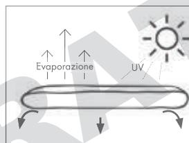
Lasciare il sacco all'azione del sole: il sacco si svuoterà rilasciando acqua sotto forma di gel, innocuo per l'uomo e l'ambiente. Una volta ingiallito, il sacco può essere smaltito nella differenziata.
