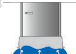
Ripiegare la copertura anti-UV sopra i sacchi coprendoli completamente per una totale protezione dai raggi del sole (i sacchi sono sensibili ai raggi-UV)
