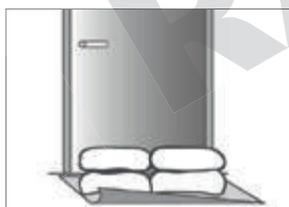
Mettere la copertura anti-UV davanti alla zona da proteggere. Posizionare i sacchi attivati sopra la copertura anti-UV in modo da essere stabili.
